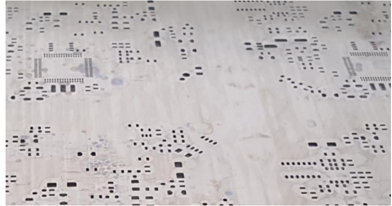
Nanovate™ Nickelschablone nach 335.000 Drucken
