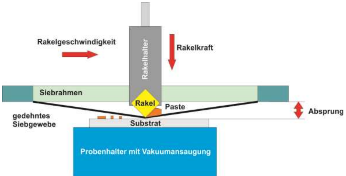
Abbildung 6: Prinzipieller Aufbau eines Siebdruckers
