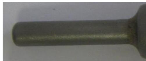
Sensor für Flüssigkeiten (Spitze \varnothing 3 mm x 15 mm)
