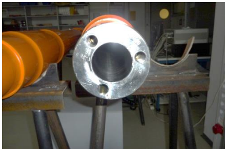
Hohlwelle Innendurchmesser Ø68
