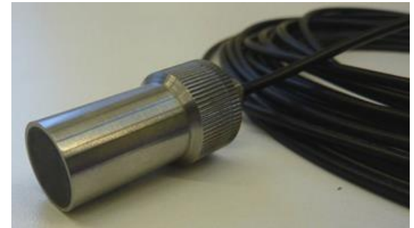
Prüfkopf mit Anpassschicht an H 2 O
