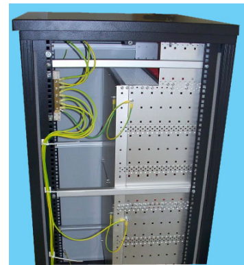
Modifizierter Schrank mit Sonder- Baugruppenträger, kompl. mit Erdung und Montage. Anwendung: Hochspannungstechnik
