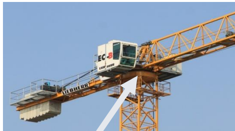
Kran mit Rollen- und Kugeldrehkranz Schraubverbindung
