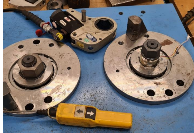
Messung Vorspannkraft auf einem genormten Prüfstand ergibt Kraft – Weg Kurve
