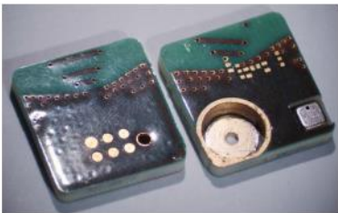
Zielgröße IOT-Sensor < 0,2 cm 3 embedded in PCB
