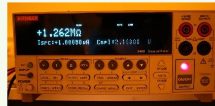
Widerstandsmessung an Lasergräben der Funktionsschicht
