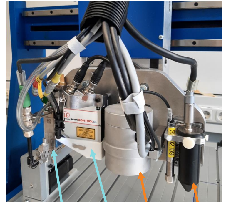
Jet-Dispenser Laserprofilscanner Infrarot-Spot Wirbelstromsensor
