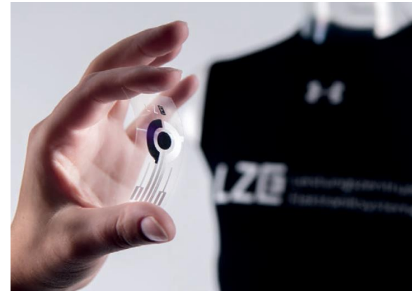
Dünnschicht-Elektrolyt-Sensor zur Schweißanalyse (Quelle: M. Jank, Fraunhofer IISB)
