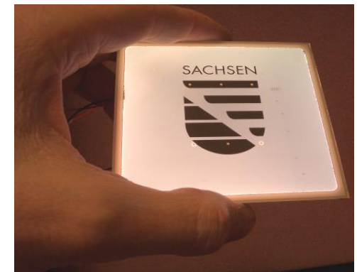
Ansicht einer Beleuchtungskachel (Kantenlänge: 85mm)
