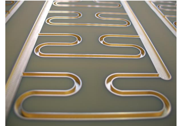
Gefräste und metallisierte IL vor dem Verpressen
