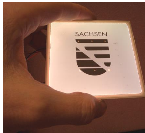
Ansicht einer Beleuchtungskachel (Kantenlänge: 85mm)
