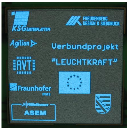
LP-Muster mit leuchtenden alphanumm. Zeichen und Symbolen [EL-Druck;., Freudenberg GmbH]
