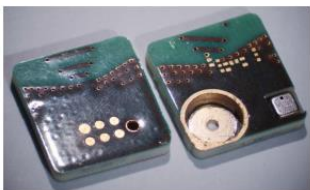
Zielgröße IOT-Sensor < 0,2 cm 3 embedded in PCB
