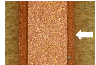
Kantenrauigkeit geätzter Kupferstrukturen
